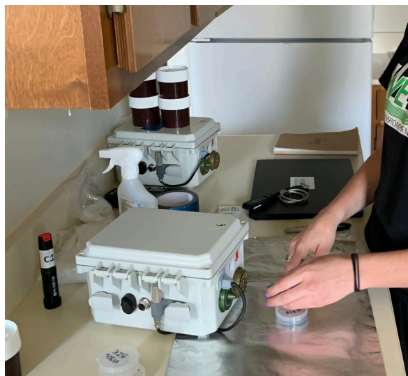
Personal de WE ACT mostrando el equipo de monitoreo que mide la calidad del aire interior (NO 2 , CO, y PM 2.5 ) durante las pruebas de estufas de gas versus estufas de inducción del programa piloto Fuera con el Gas, Adentro con la Justicia (Out of Gas, In with Justice) en viviendas asequibles de la ciudad de Nueva York.
